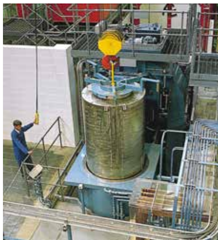
Загрузка контейнера с деталями в промышленный газостат
