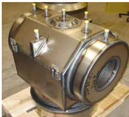
Форма, которую в компании «Ролмс-Ройс» применяют для получения деталей методом горячего изостатического прессования. Видны технологические отводки для засыпки порошка
