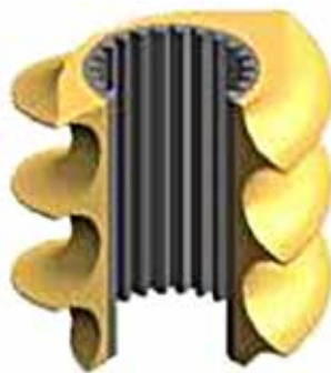
Внутреннюю часть шнека для подачи пластиковых гранул сначала выточили из вязкой стали, а наружную, с архимедовым винтом, — из твердого материала — нанесли с помощью горячего изостатического прессования. Так нужно потому, что внешняя часть шнека испытывает износ, в то время как внутренняя должна сопротивляться ударным нагрузкам, с чем твердый, но хрупкий материал плохо справляется
