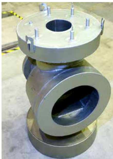
Вес корпуса трубопроводного клапана, сделанного без помощи сварки методом горячего изостатического прессования, может достигать нескольких тонн
