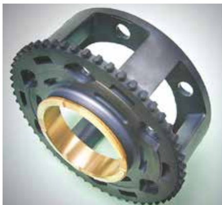
Эта шестеренка стоит в трансмиссии автомобилей «фольксваген туарег» и «порше кайен». Две части детали штампуют по отдельности, а затем соединяют их во время спекания. Так удается снизить трудозатраты
